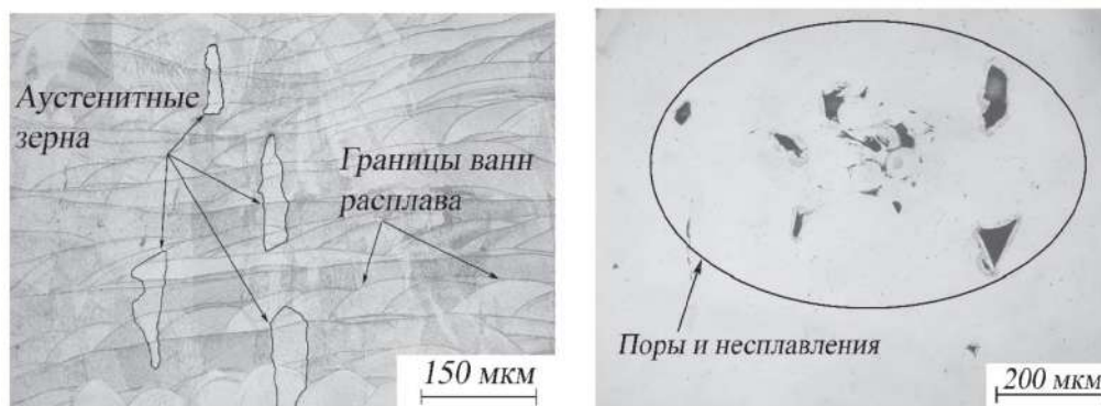
Рисунок 7. Структура стали 316L, изготовленной методом селективного лазерного сплавления
