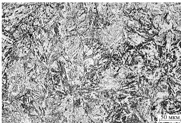
Рисунок 8. Микроструктура стали 15X13H2 в исходном состоянии (сорбит отпуска)
